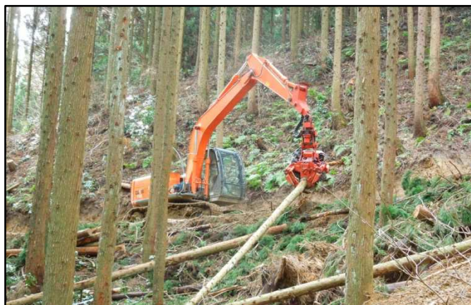
高性能林業機械(プロセッサー)による 間伐木の処理作業の様子
